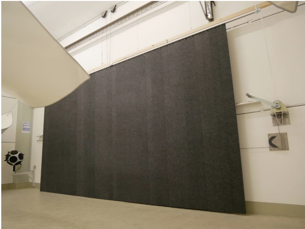
Abbildung B.3. Prüfanordnung im Hallraum, Öffnungswinkel 0° – geschlossen, 150 mm Wandabstand.
